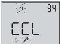
Schließrichtung (Drehrichtung, durch die die ZU-Stellung des Stellventils erreicht wird; Blickrichtung auf Display des Stellungsreglers) Standard: CCL (gegen den Uhrzeigersinn)
