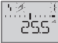
Code 1 Ventil mit Sternknopf ver- stellen, aktueller Drehwinkel wird angezeigt
